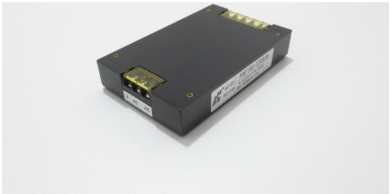
开关型直流稳压电源通过控制调整管的通断时间实现稳压，驱动调整管的电压可以是方波脉宽调制电压，也可以是正弦波的谐振电压。它的电路型式主要有单端反激式、单端正激式、半桥式、推挽式和全桥式。它和线性稳压电源的根本区别在于电路中的变压器不工作在工频而是工作在几十kHz到几MHz，功率管不是工作在线性区，而是饱和及截止区，即工作在开关状态；开关型直流稳压电源也因此而得名。开关电源适用于全电压范围，不需要压差，可以采用不同的电路拓扑实现不同的输出要求。调整率和输出纹波不如线性电源，效率高。需要外面元件多，成本高。电路相对复杂。开关电源的效率相对较高，而且效率不随输入电压的升高而降低，电源通常不需要大散热器，体积较小，因此在很多应用场合成为必然之选。开关电源按转换方式可分为斩波型、变换器型和电荷泵式，按开关方式可分为软开关和硬开关。交流稳压电源的作用，欢迎咨询杭州品深电源科技有限公司。上海DC48V转DC12V稳压电源现货
