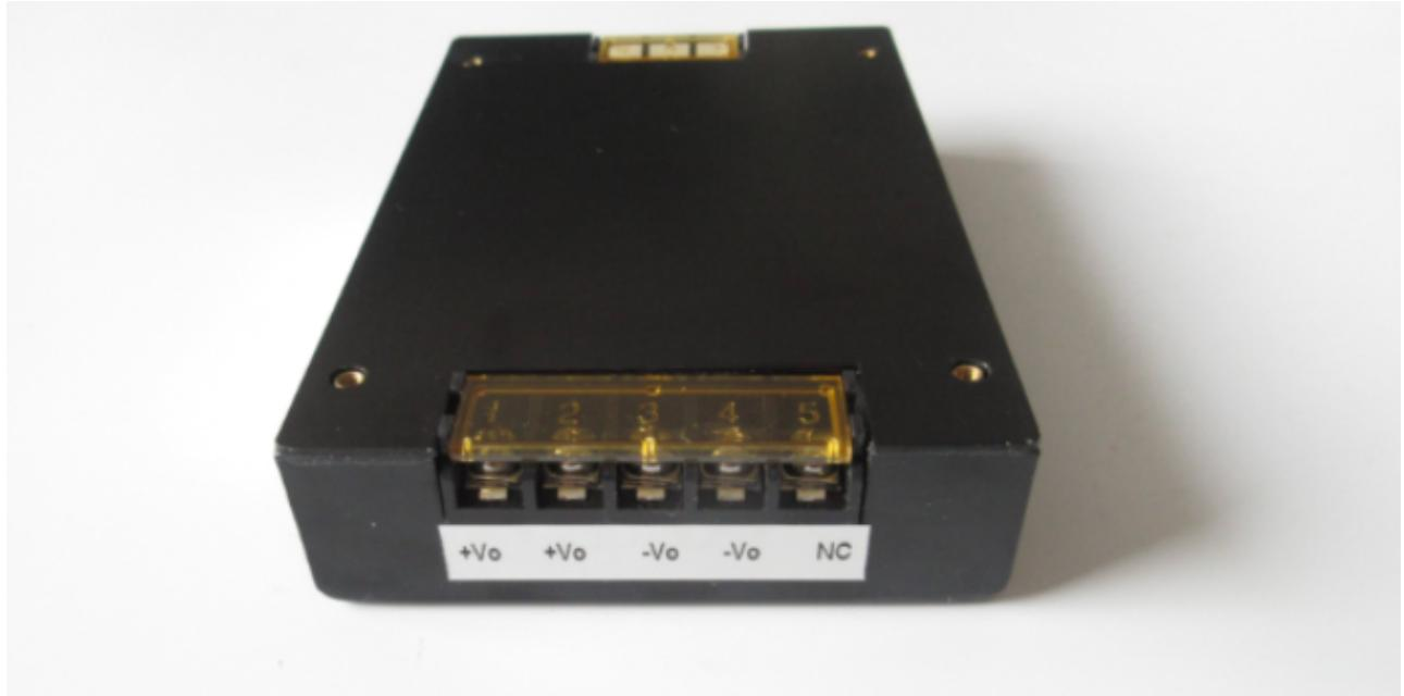
当环境温度变化时，会引起输出电压的漂移。良好的稳压电源，应在环境温度变化时，有效地抑制输出电压的漂移，保持输出电压稳定，输出电压的漂移用温度系数 $K_T$ 来表示。所谓纹波电压，是指输出电压中50赫或100赫的交流分量，通常用有效值或峰值表示。经过稳压作用，可以使整流滤波后的纹波电压很大降低，降低的倍数反比于稳压系数 $S$ 。增加放大环节，提高稳定性，使输出电压可调；用复合管做调整管，使输出电流增大；增加保护电路，使电源工作安全可靠。
